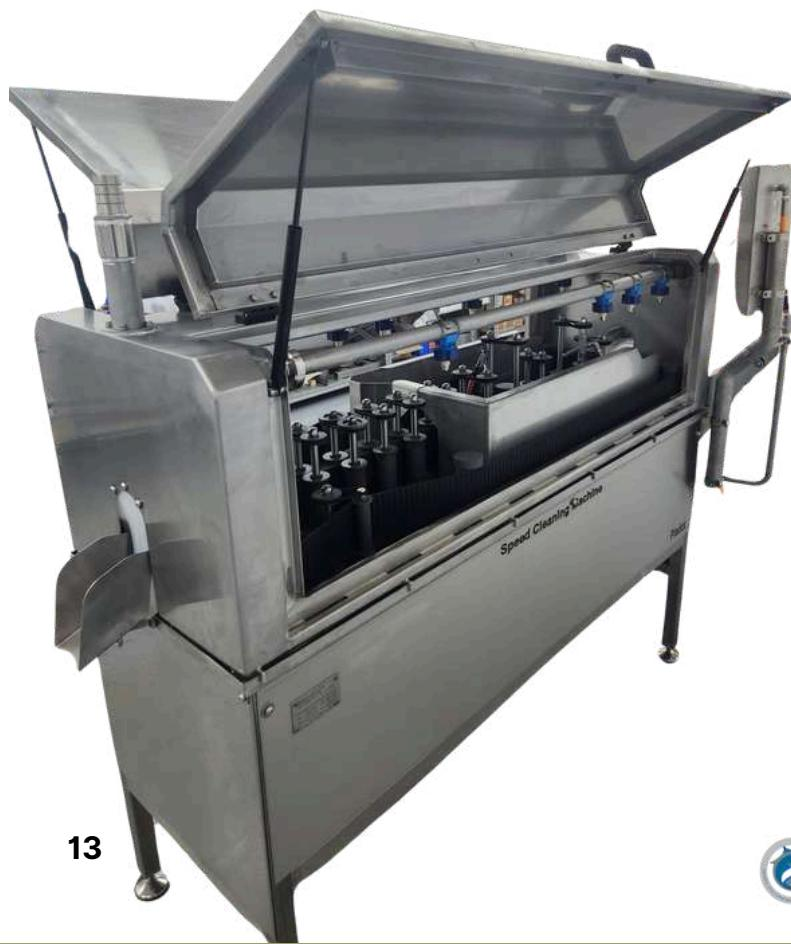
A Speed Cleaning Machine revoluciona a indústria da piscicultura com seu uso inovador de Jatos de água de alta pressão para limpar até 28 peixes por minuto de forma eficiente e precisamente.
